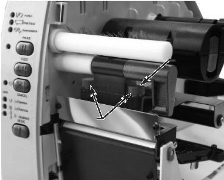
2. Mettre le capteur (sensor) dans le fond complètement
